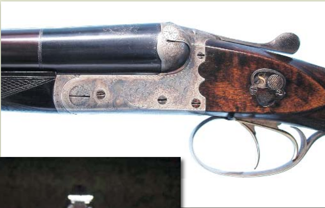
Илл. 8. Бескурковый бюксфлинт (двойник или егерское ружьё) с коробчатыми замками, тройным запиранием, нижними шепталами и верхними перехватывателями курков
